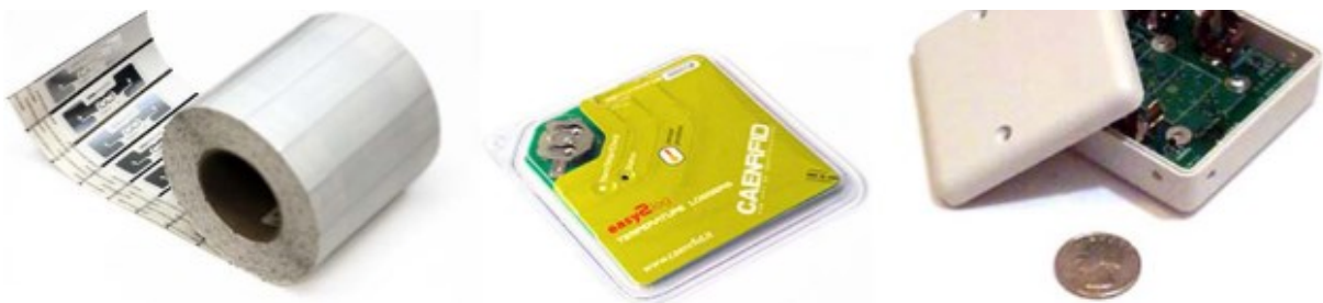
Slika 3. Primjeri RFID transpondera (pasivni, polupasivni i aktivni) [4]
