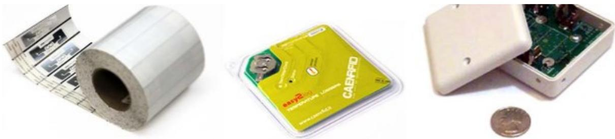
Slika 3. Primjeri RFID transpondera (pasivni, polupasivni i aktivni) [4]
