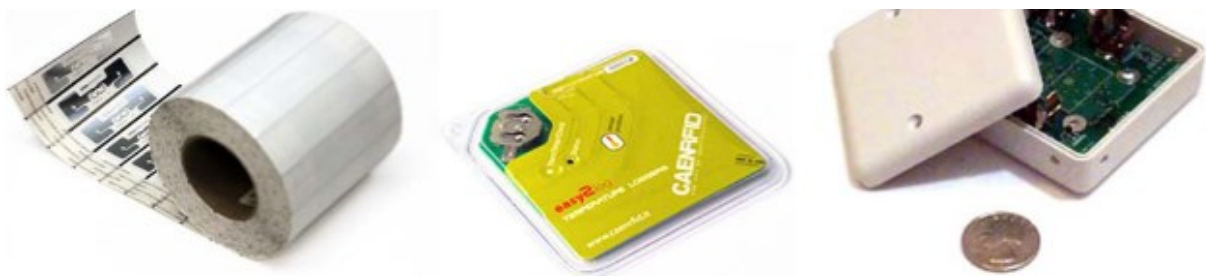
Slika 3. Primjeri RFID transpondera (pasivni, polupasivni i aktivni) [4]
