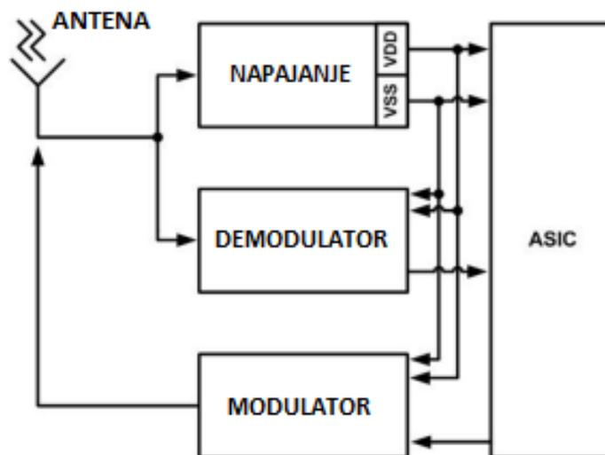
Slika 10. Osnovna arhitektura pasivnih RFID transpondera [9]
