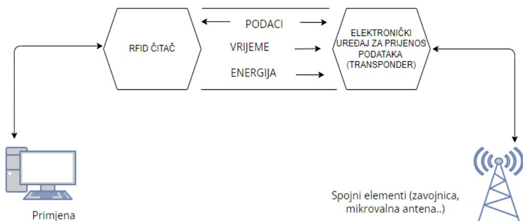
Slika 1. Prikaz glavnih komponenti RFID sustava [2]
