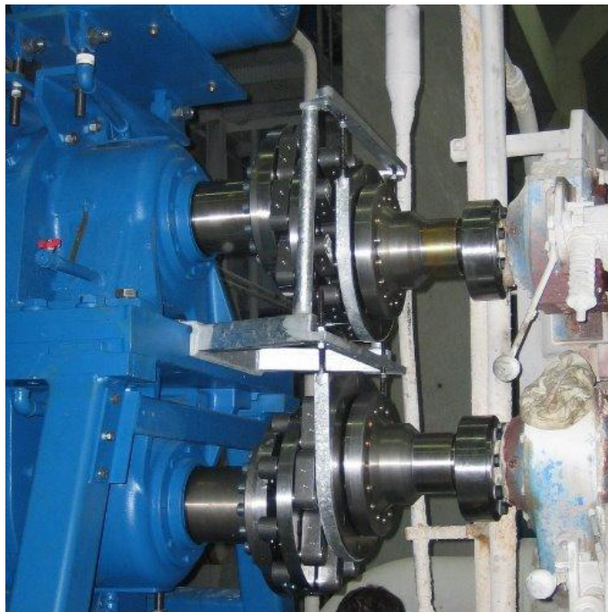
Slika 12.9. upotreba Schmidtove spojke [12]
