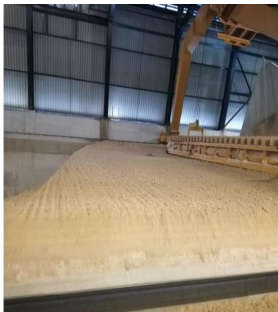
Slika 31. Nagomilavanje gipsa strugalom.
