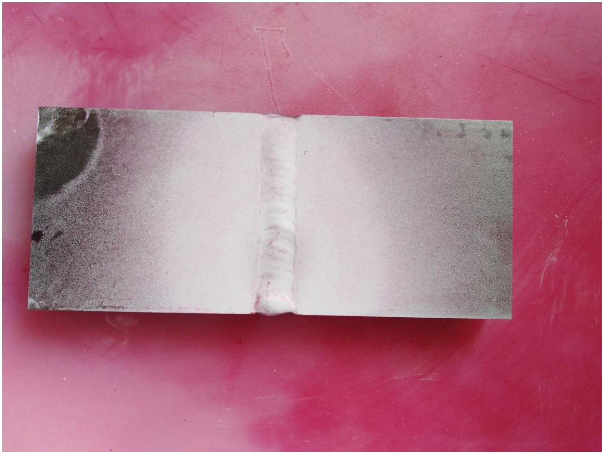
Slika 39 Ispitni objekt 1 razvijač osušen
