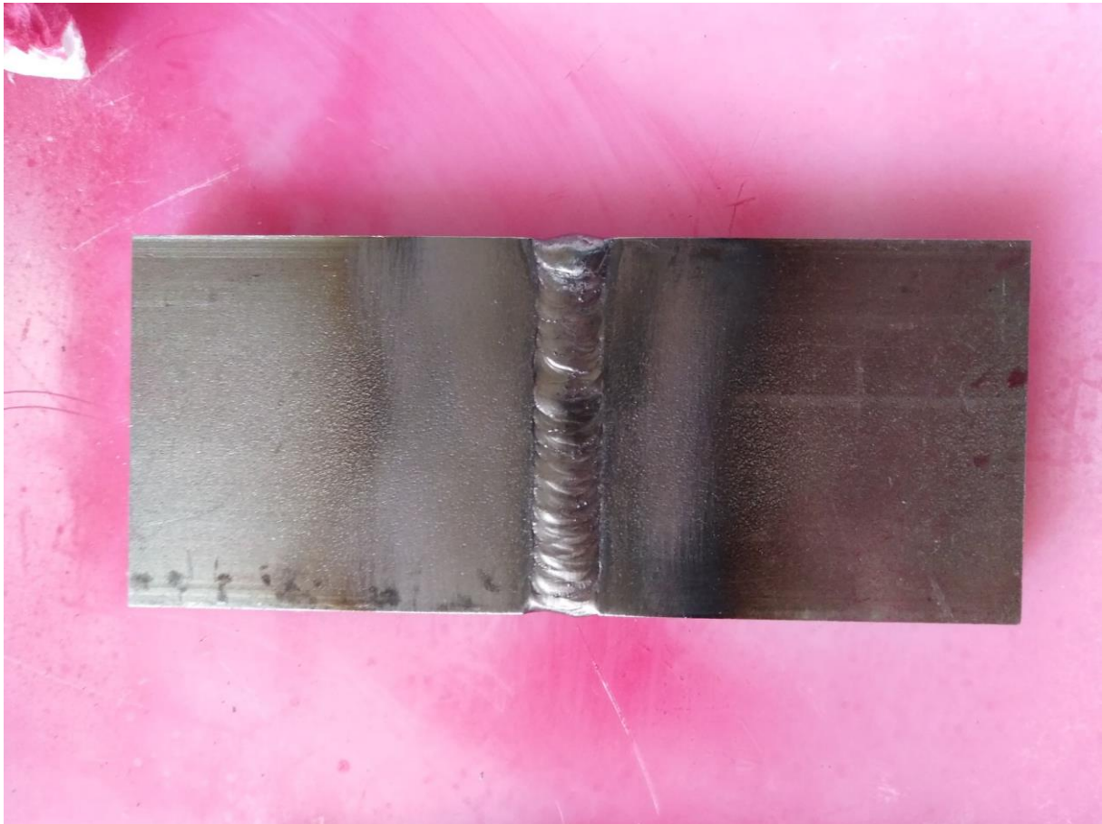
Slika 35 Očišćeni ispitni objekt 1 spreman za nanošenje penetranta
