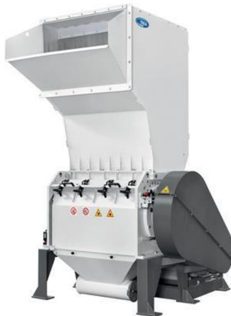
Slika 18. Mlin za mljevenje plastike [5]
