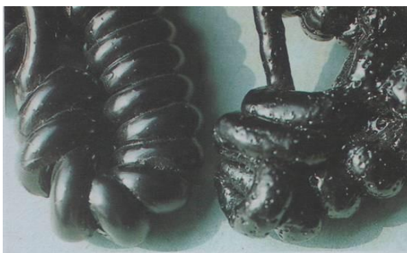
Slika 14. Provjera količine vlage u materijalu [6]
