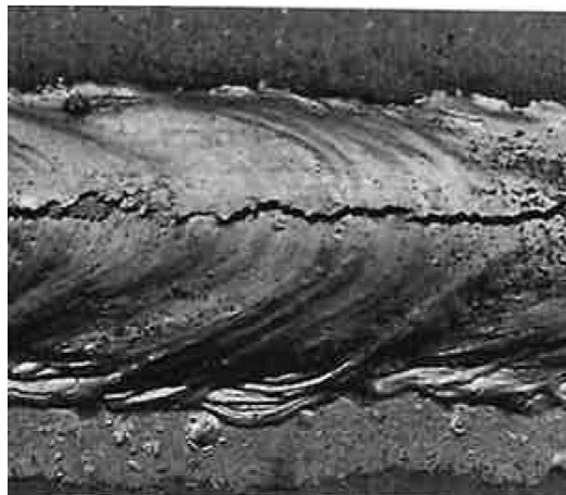
Slika 28. Topla pukotina, lice zavarenog spoja [24]
