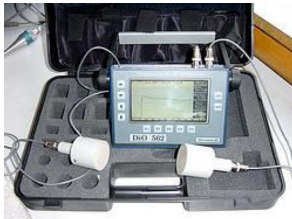
Slika 37. Uređaj za ultrazvučno ispitivanje [30]
