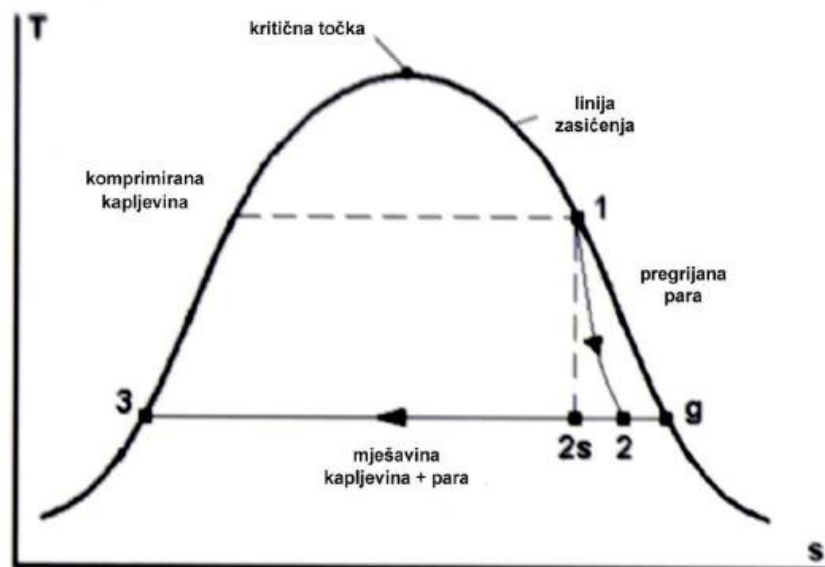
Slika 3. T-s dijagram postrojenja sa suhozasićenom parom [5]
