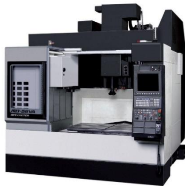
Slika 21. Glodaći obradni centar OKUMA ACE CENTER MB-56VA [22]
