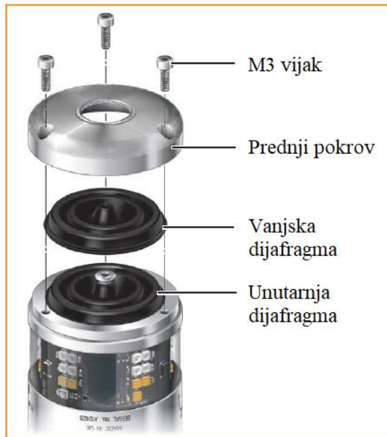
Slika 27. Pregleda stanja, odnosno vidljivih znakova oštećenja, te zamjena vanjske dijafragme 3D mjernu glavu [21]
