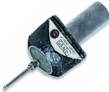
Slika 8. Prva mjerna glava s kontaktnim ticalom [16]
