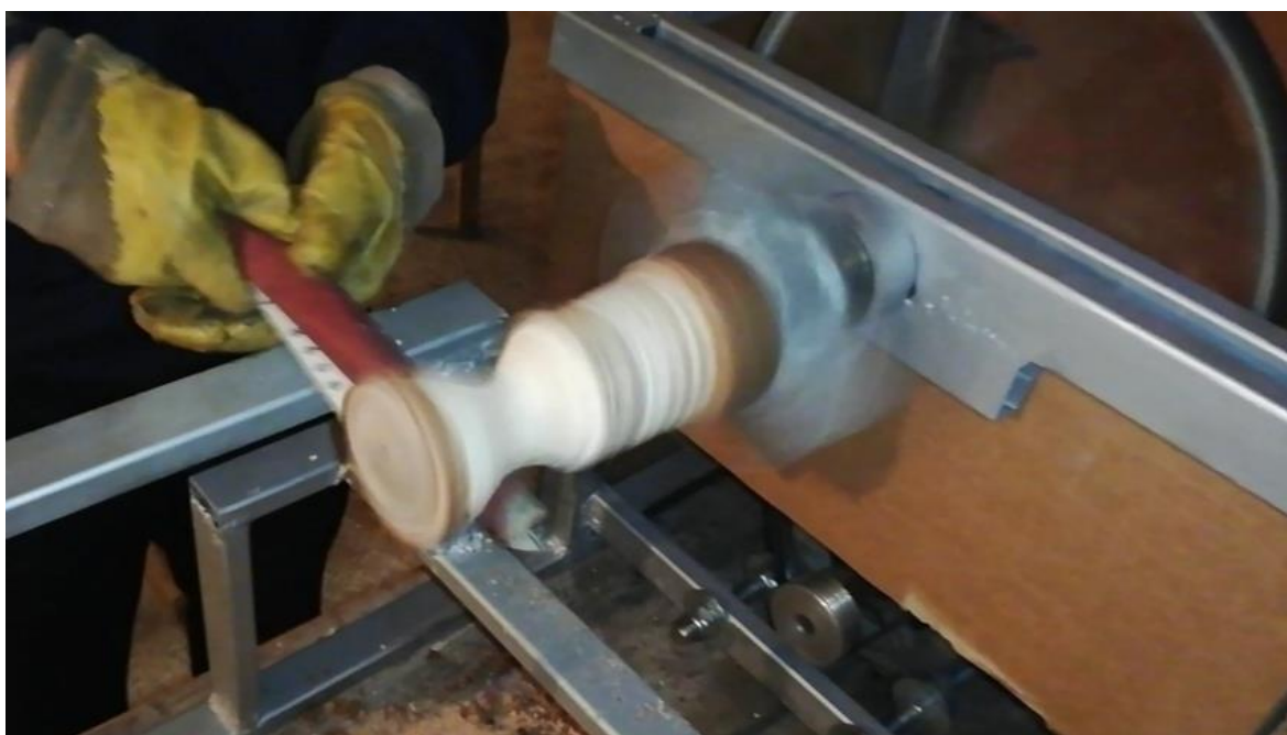
Slika 35. Obrada drva brusnim papirom
