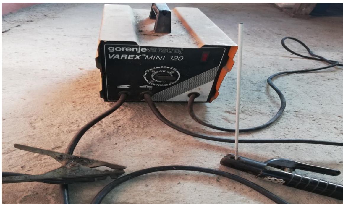
Slika 28. Aparat za zavarivanje
