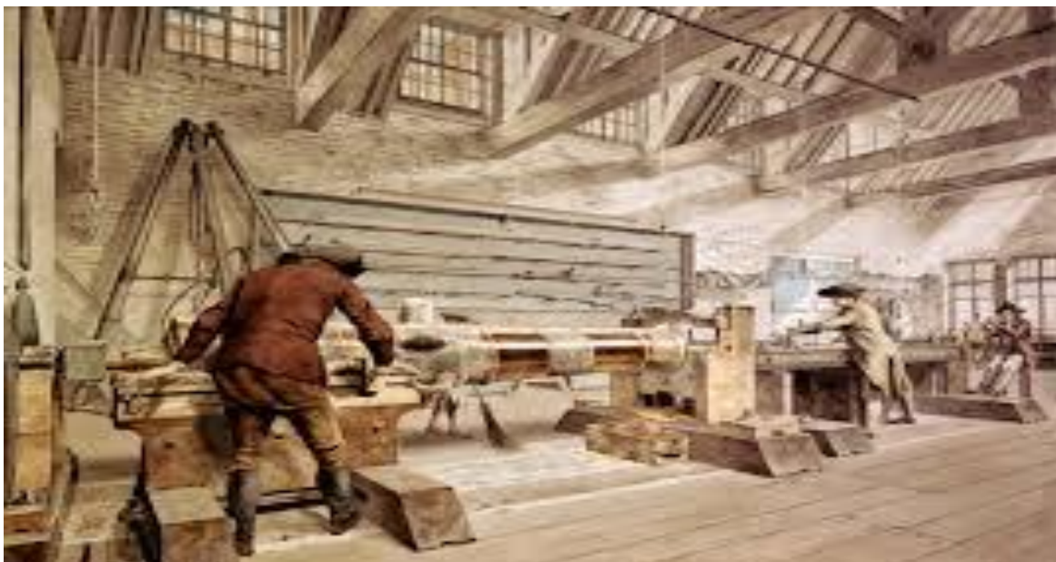
Slika 4. Stroj za horizontalno bušenje [5]
