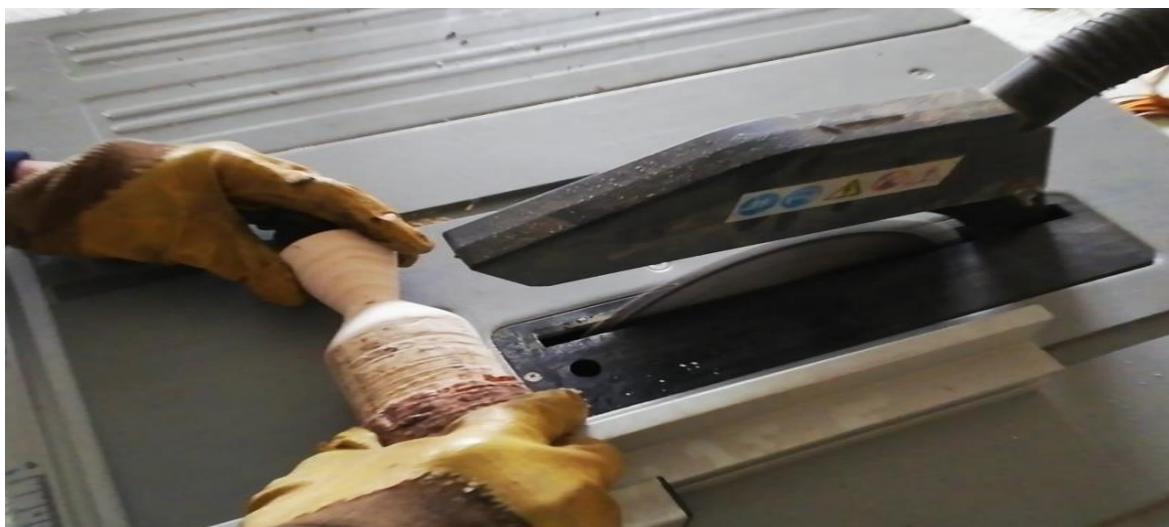
Slika 36. Uklanjanje obradka od viška materijala
