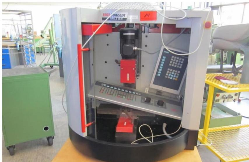
Slika 6. Shematski prikaz stroja EMCO PC MILL 55 [10]
