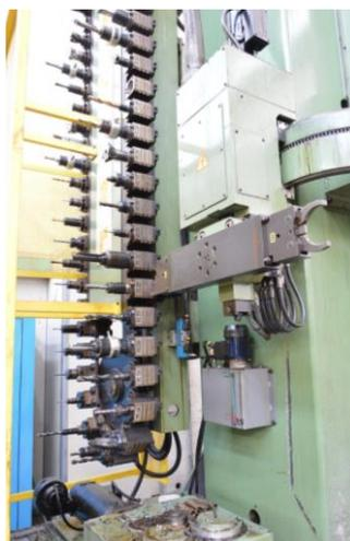
Slika 10. Lančani nosač alata [15]
