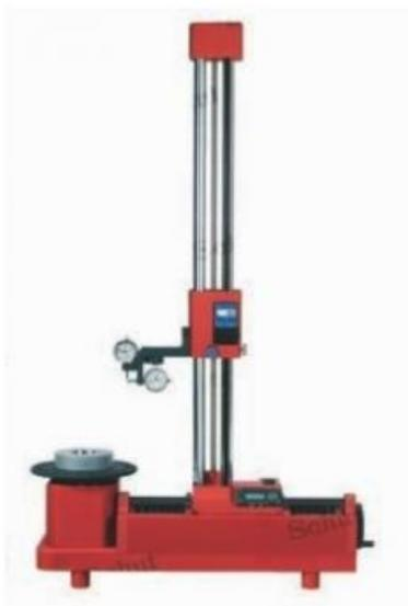
Slika 9. Uređaj za prednamještanje alata [18]
