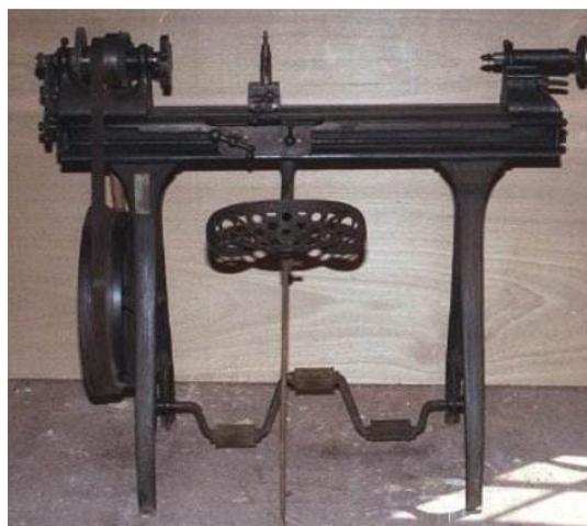
Slika 1.1. Prvi tokarski stoj [1]
