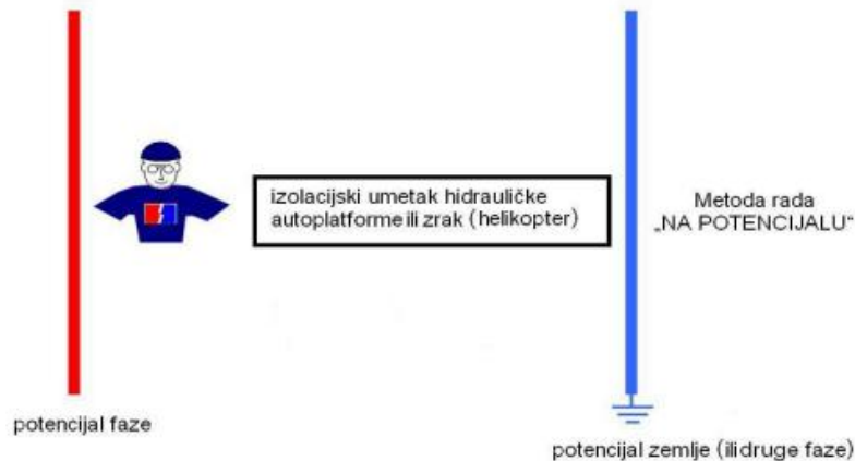
Slika 14. Metoda rada „na potencijalu“
