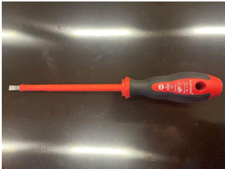
Slika 7. Izolirani odvijač 1000V [Vlastiti izvor]
