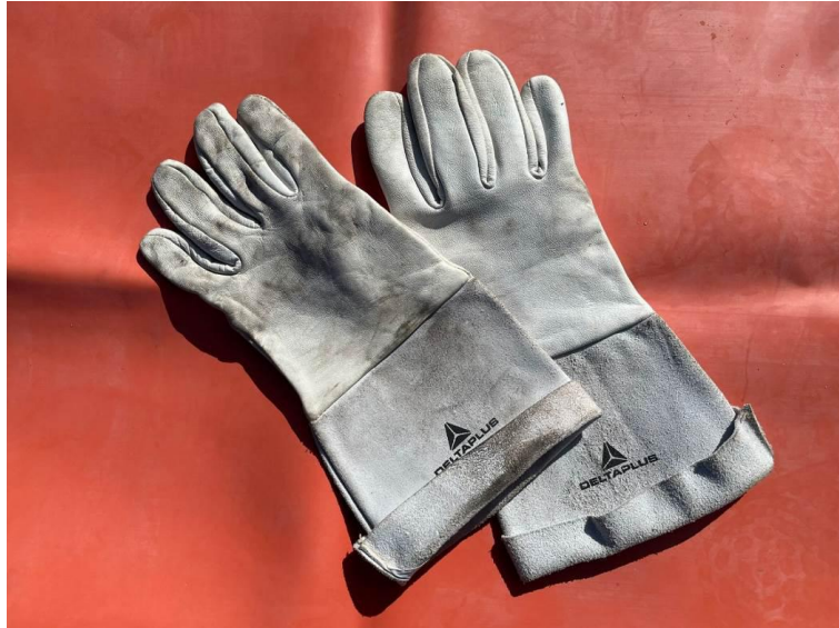
Slika 4. Zaštitne kožne rukavice (nadrugavice) [Vlastiti izvor]
