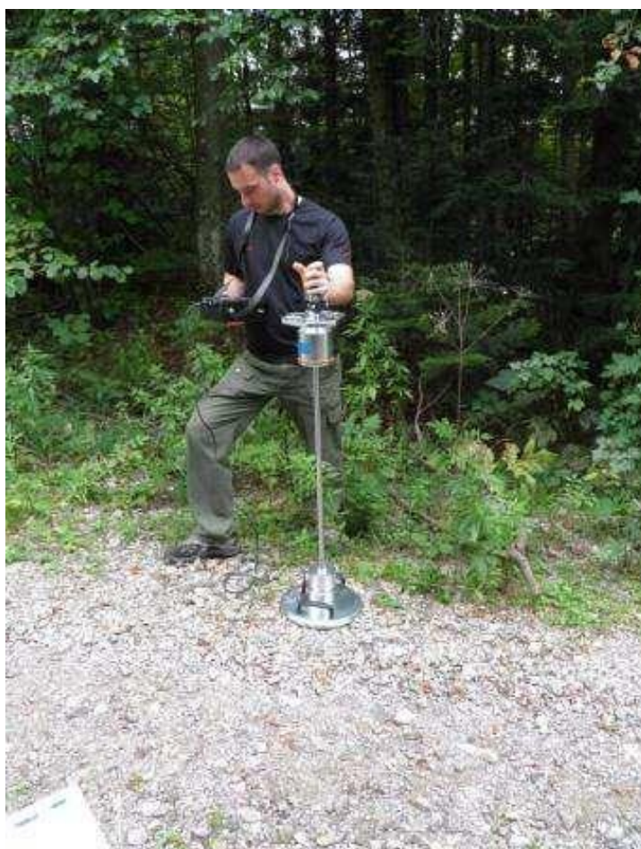
Slika 7. Provedba mjerenja nosivosti šumske ceste (Branišelj, S. 2013)
