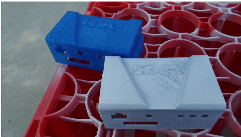
Slika 35. PLA proizvod nakon i prije nanošenja prevlake
