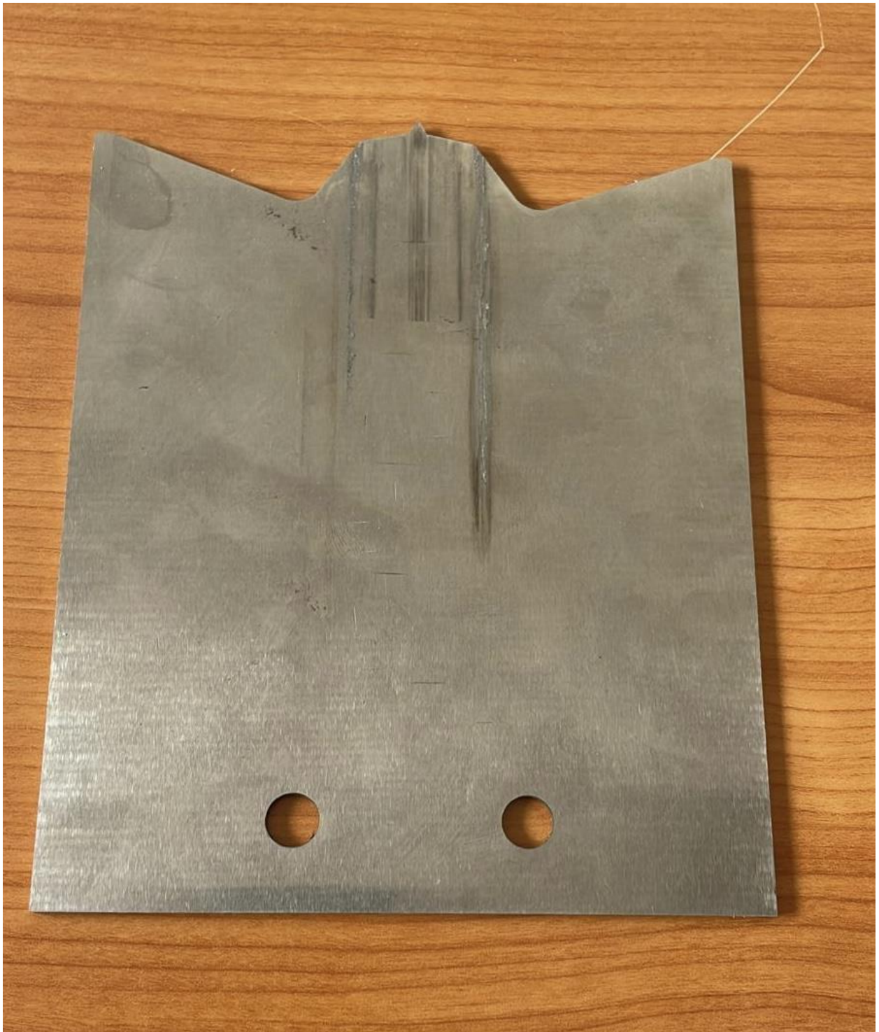
Slika 18 Slika noža bez PVD prevlake na kojem se već nakon 60 minuta rada vide oštećenja. (vlastiti izvor)
