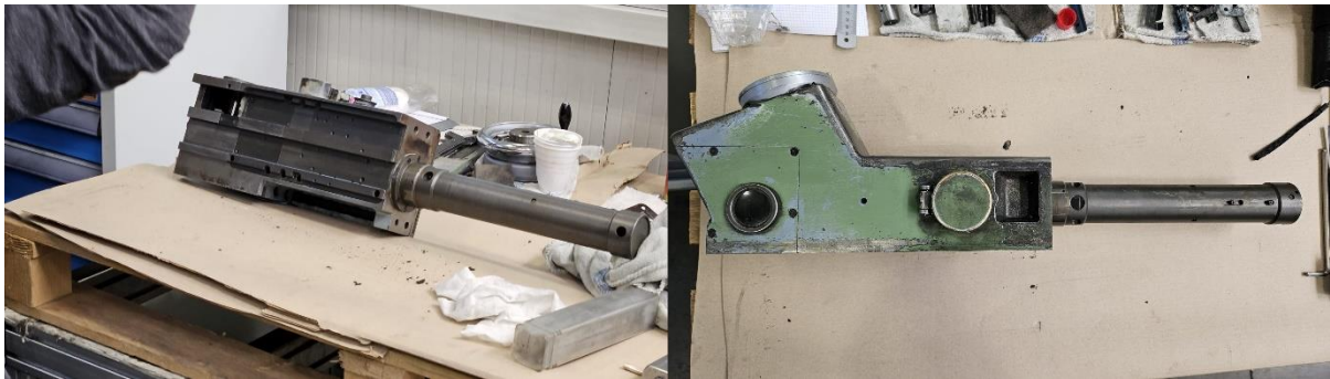
Slika 27. Optika za pozicioniranje (x-os) [Autor]
