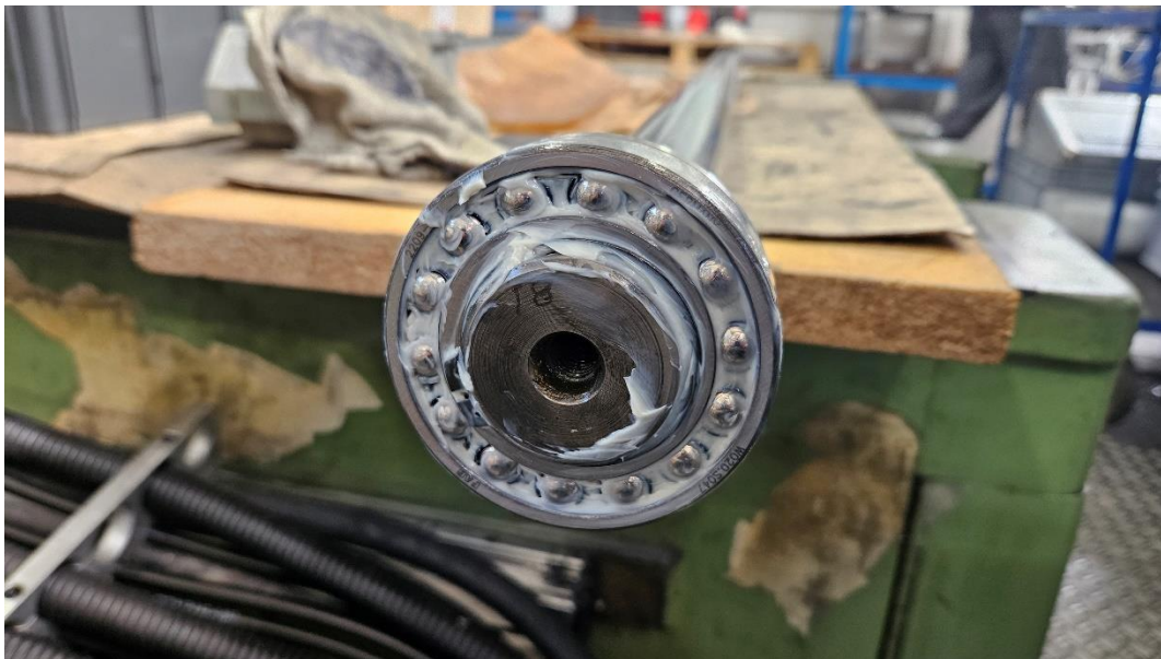
Slika 22. Novi kuglični ležaj vretena[Autor]
