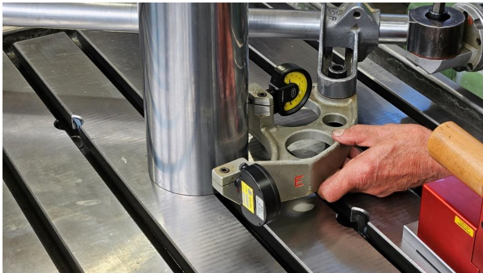
Slika 46. Mjerenje ravnosti kliznih staza[Autor]
