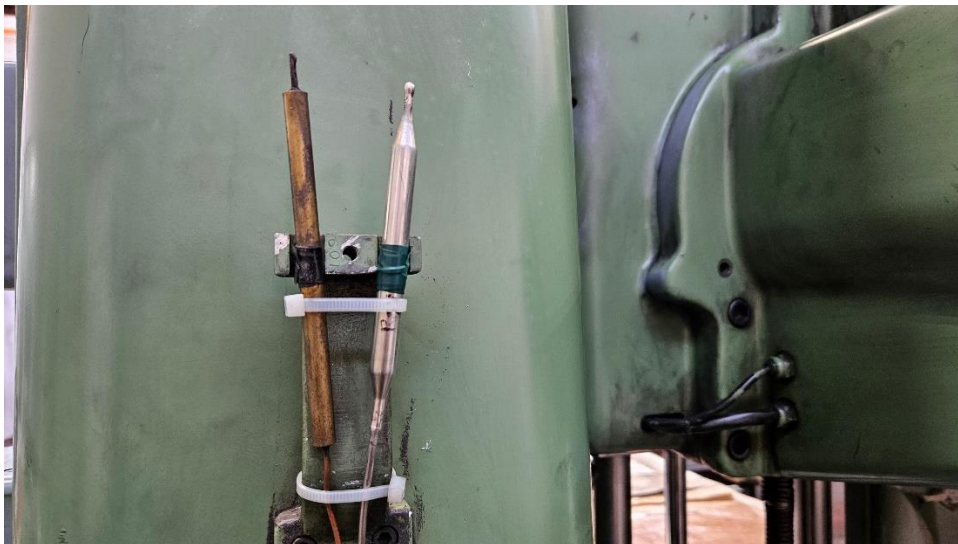
Slika 30. Novi termo par(desno) za mjerenje temperature okoline[Autor]
