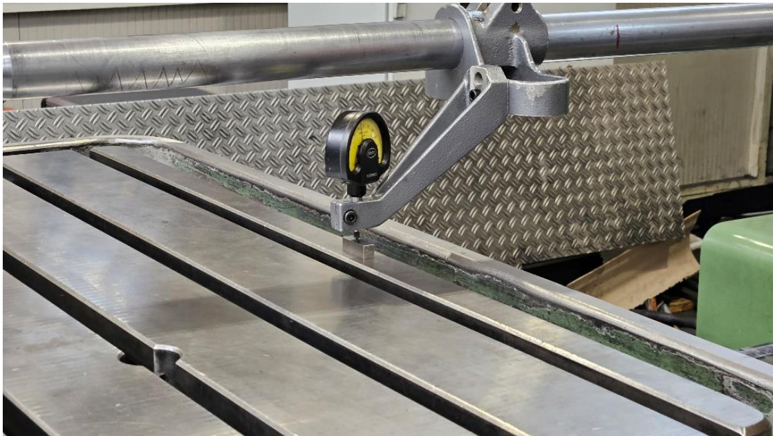
Slika 41. Ispitivanje paralelnosti površine s kliznim stazama stola[Autor]
