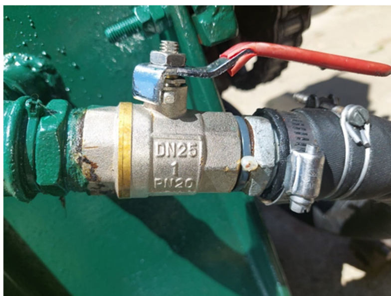
Slika 27. Hidraulički protočni ventil
