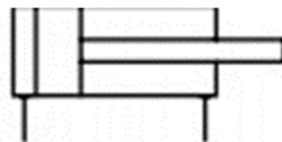
Slika 33. Simbol dvoradnog cilindra
