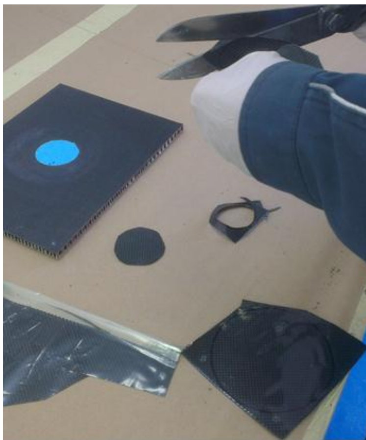
Slika 70. Rezanje drugog i trećeg sloja
