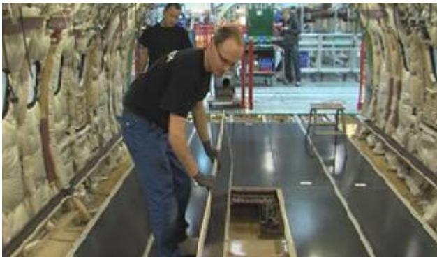
Slika 52. Zrakoplovni podni paneli
