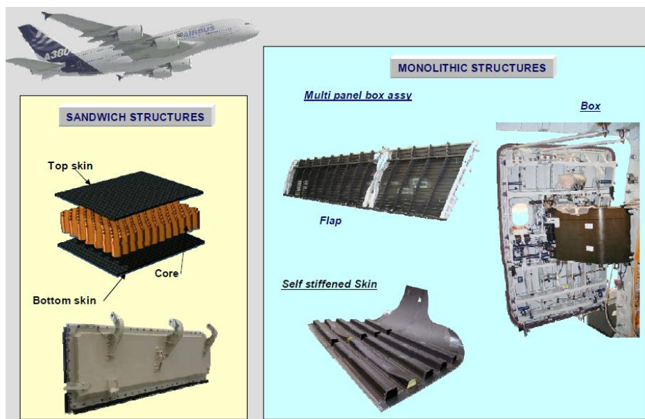
Slika 31. Vrste složenih kompozita u strukturi zrakoplova [3]
