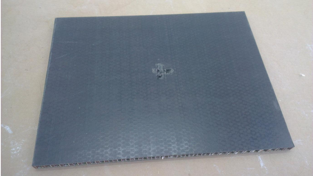
Slika 51. Uzorak podnog panela u zrakoplovu
