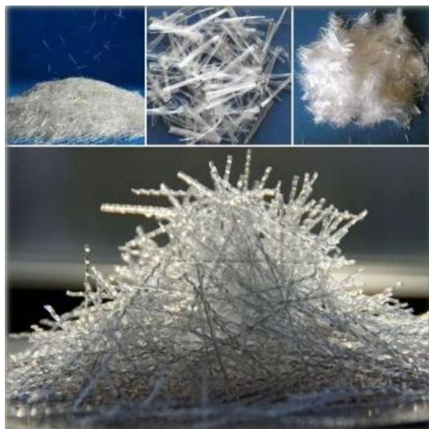
Slika 7. Filamenti staklenih vlakana [16]
