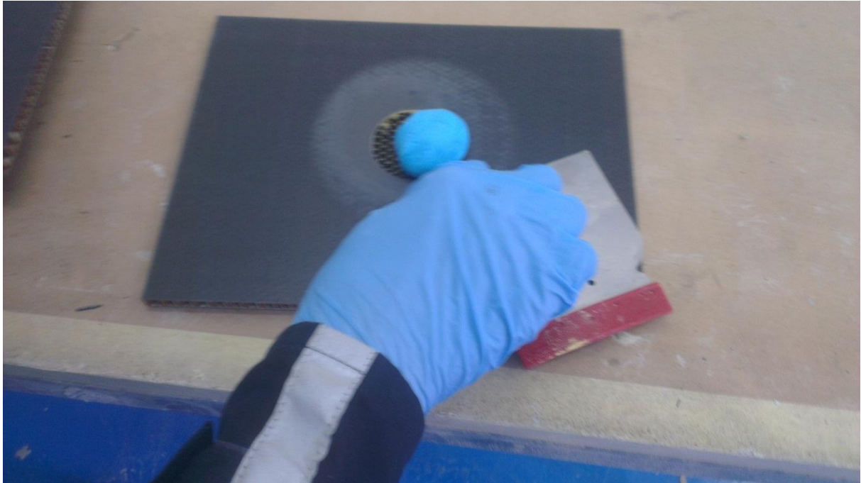
Slika 60. Nanošenje pjenastog punila
