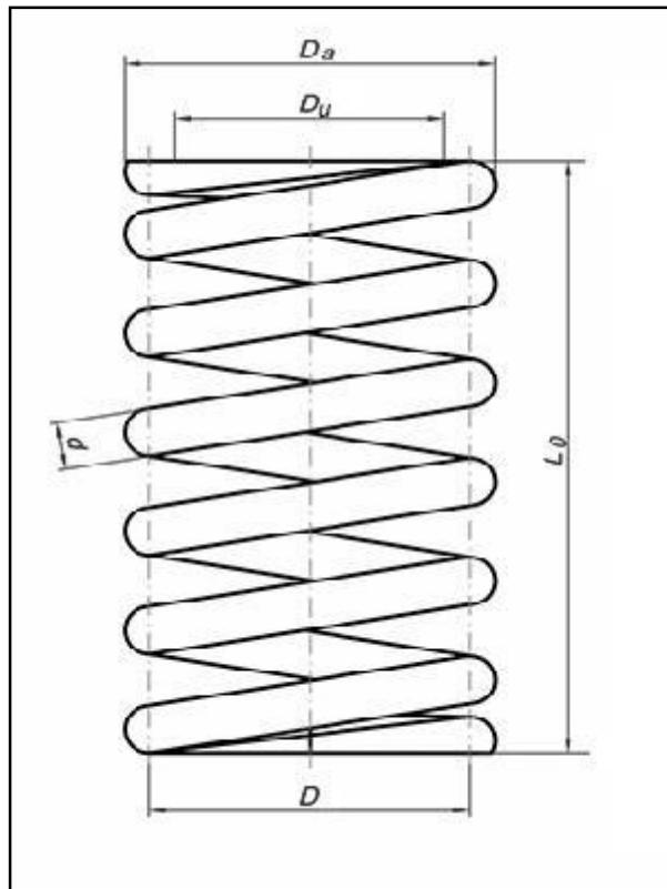
Slika 26. Cilindrična tlačna opruga od žice okruglog presjeka [1]
