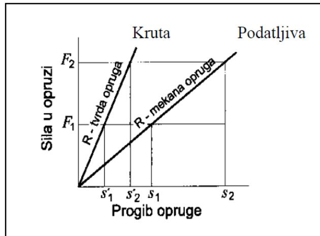
Slika 3. Dijagram usporedbe tvrde i meke opruge za linearu karakteristiku
