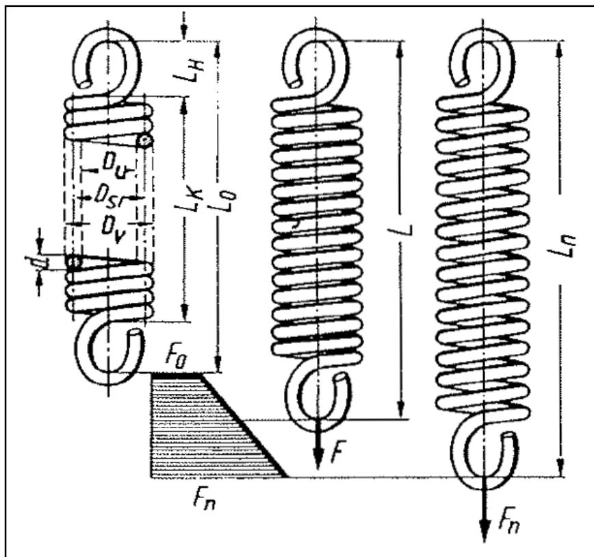
Slika 29. Vlačna opruga namatana s predopterećenjem [1]
