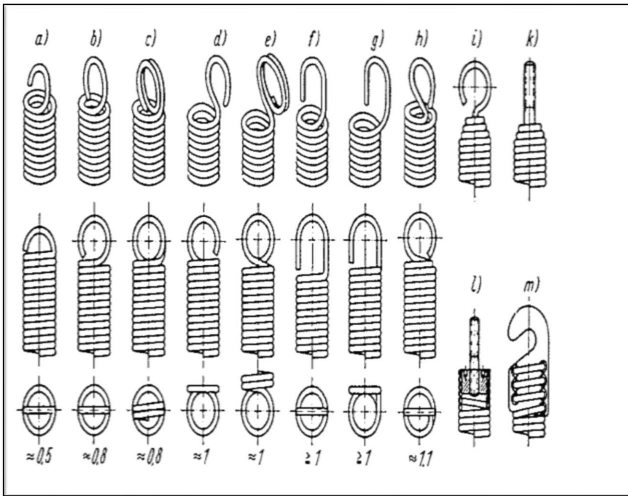
Slika 30. Oblici ušica vlačnih opruga prema DIN 2097 : a) polovična njemačka ušica; b) cijela njemačka ušica; c) dvostruka njemačka ušica; d)cijela njemačka ušica sa strane dignuta ; e) njemačka dvostruka ušica sa strane dignuta; f) kuglasta ušica; g) kukasta ušica sa strane dignuta; h) engleska ušica; i) kuka uvaljana; k) svornjak s navojem uvaljan; l) čep s navojem uvijen; m) plosnata ušica uvijena [1]
