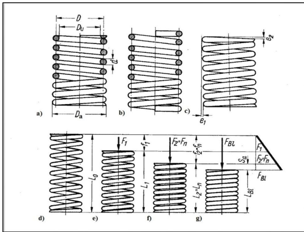
Slika 27. Stanja opruge: a) krajnji navoji prilegnuti i brušeni, b) krajnji navoji prilegnuti, c) odstupanja oblika, d) neopterećena opruga, e) opruga opterećena silom  $F_1$ , f) opruga opterećena silom  $F_2$ , g) stisnuta duljina bloka) [1]
