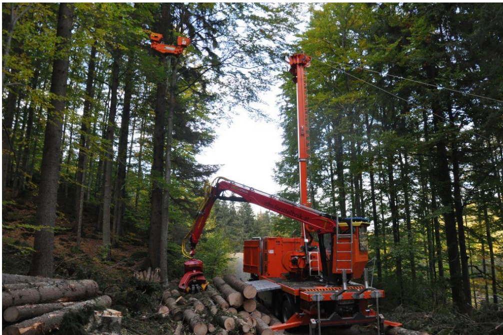
Slika 4: Vučena šumska žičara s vlastitim pogonskim uređajem na priključnom vozilu (( https://holz.fordaq.com/fordaq/news/Austrofoma_Seilkran_Koller_Konrad_Mayr_Melnhof_44312.html )
