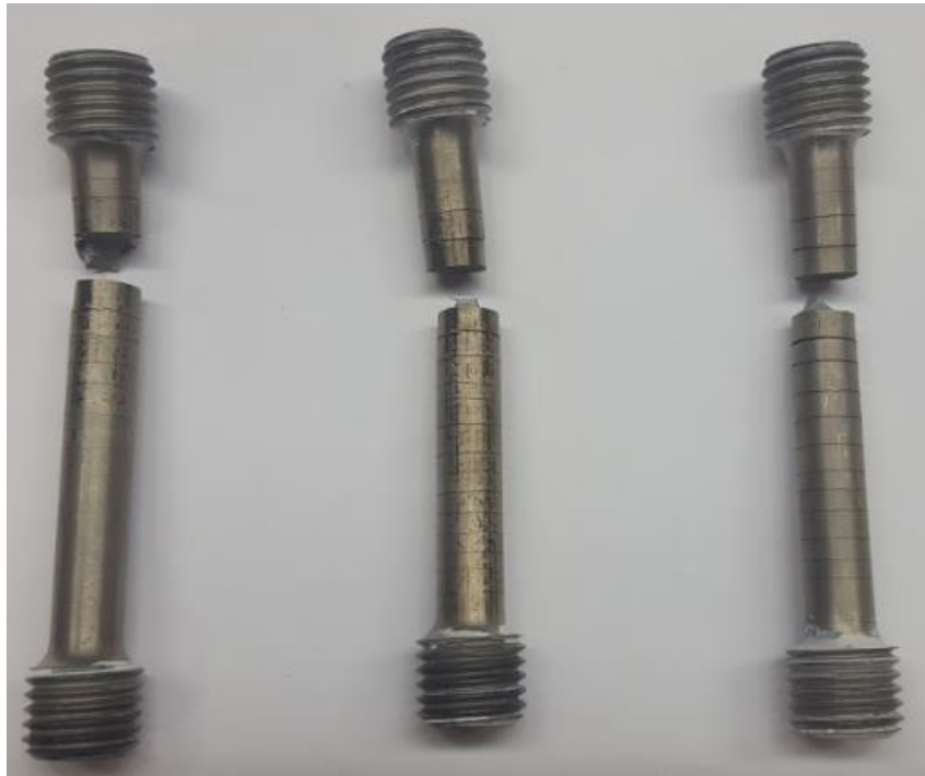
Slika 31: Epruvete nakon vlačnog ispitivanja
