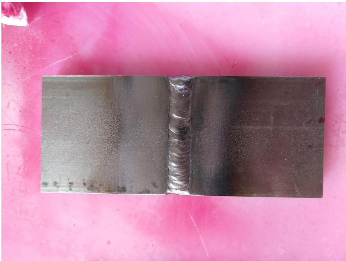
Slika 35 Očišćeni ispitni objekt 1 spreman za nanošenje penetranta
