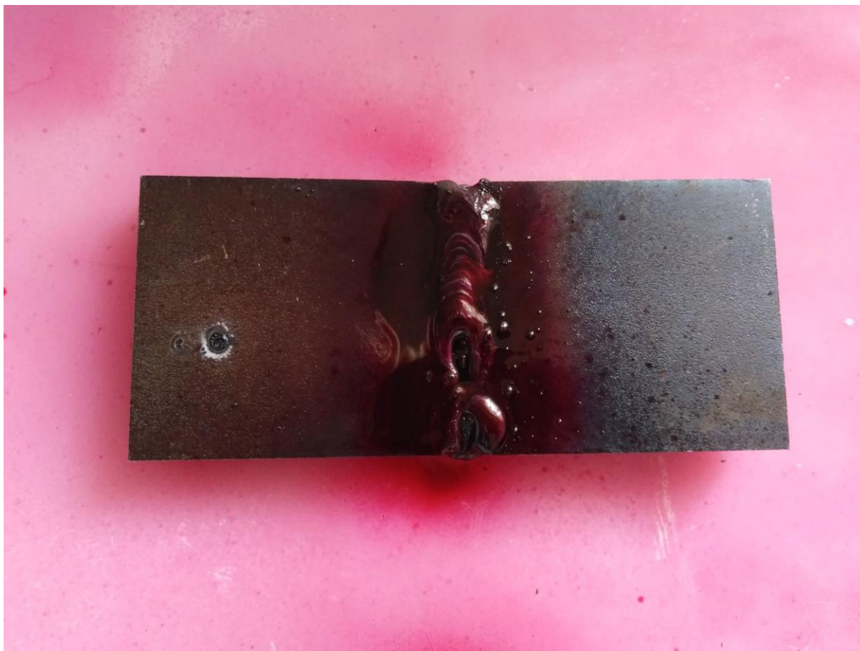
Slika 38 Nanošenje penetranta na površinu zavora ispitnog objekta 2
