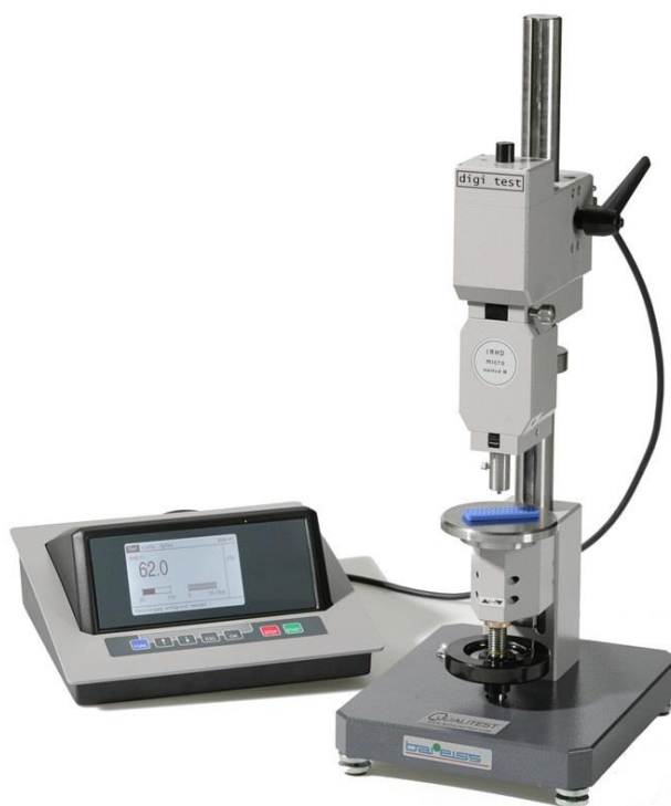
Slika 8 Ispitivanje tvrdoće po Shoreu [20]
