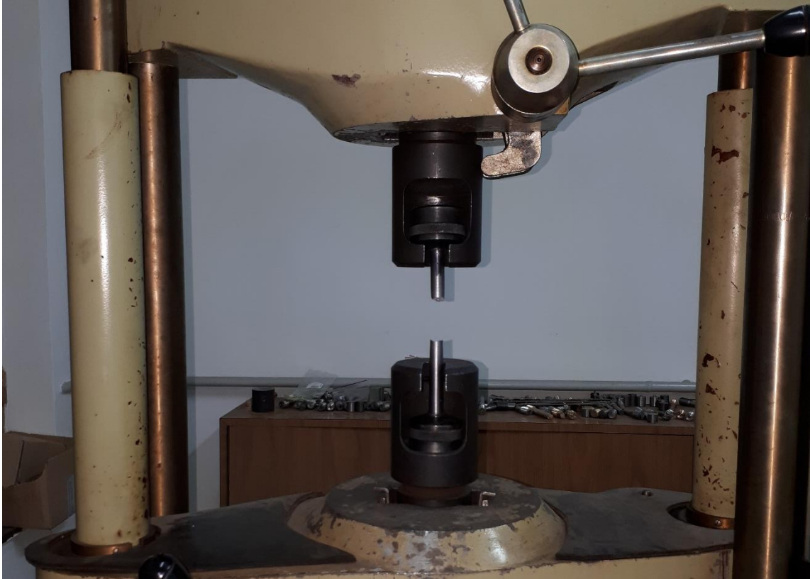
Slika 14. Epruveta nakon opterećenja
