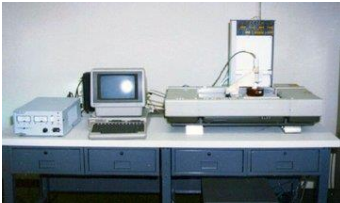
Slika 1. Prvi 3D printer koji je izumio Charles Hull [2]
