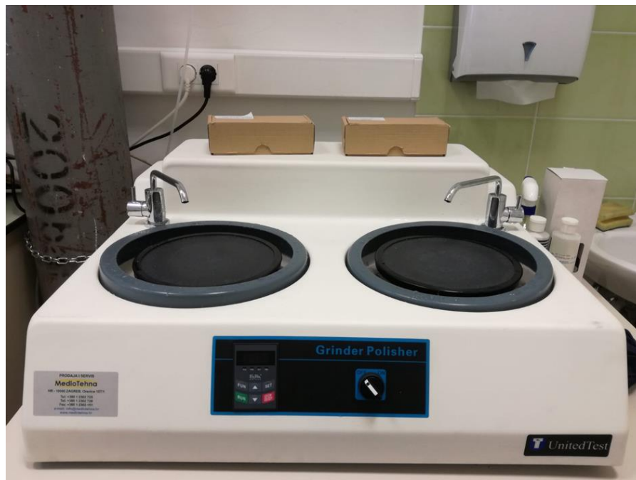
Slika 22. Uređaj za brušenje i poliranje
