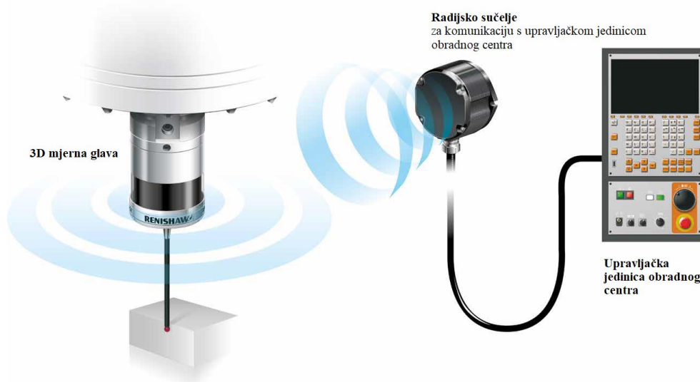
Slika 17. Radijski sustav za prijenos podataka [16]
