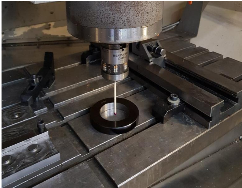
Slika 39. Kontaktno ticalo 3D mjerne glave približno postavljeno u centar kontrolnog prstena
