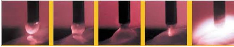
Slika 24. STT postupak zavarivanja [24]
