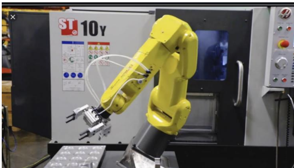
Slika 11. Automatska izmjena obradaka pomoću robota [16]
