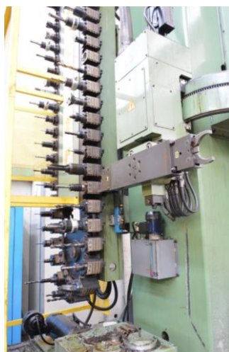
Slika 10. Lančani nosač alata [15]
