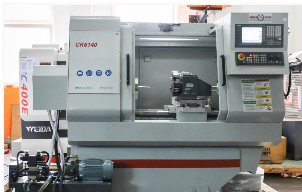
Slika 1.2. Suvremeni CNC tokarski obradni centar [2]
