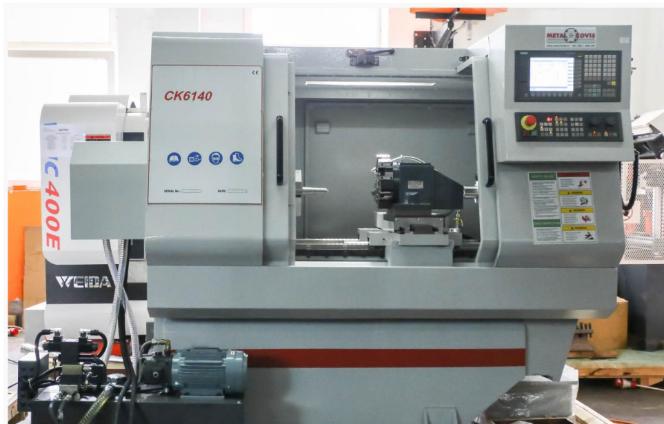
Slika 1.2. Suvremeni CNC tokarski obradni centar [2]
