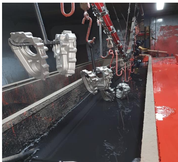
Slika 41.: Uranjanje odljevaka u bazen sa bojom[10]
