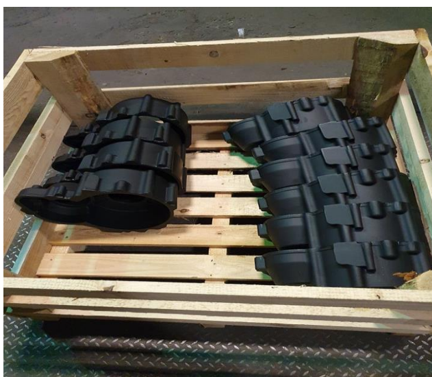
Slika 42.: DANA 104 nakon nanošenja premaza[10]
