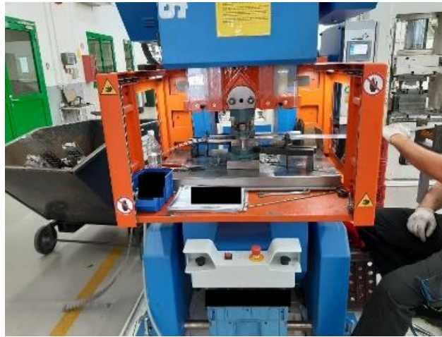
Slika 52 Predodžba ručnog posmaka trake.
