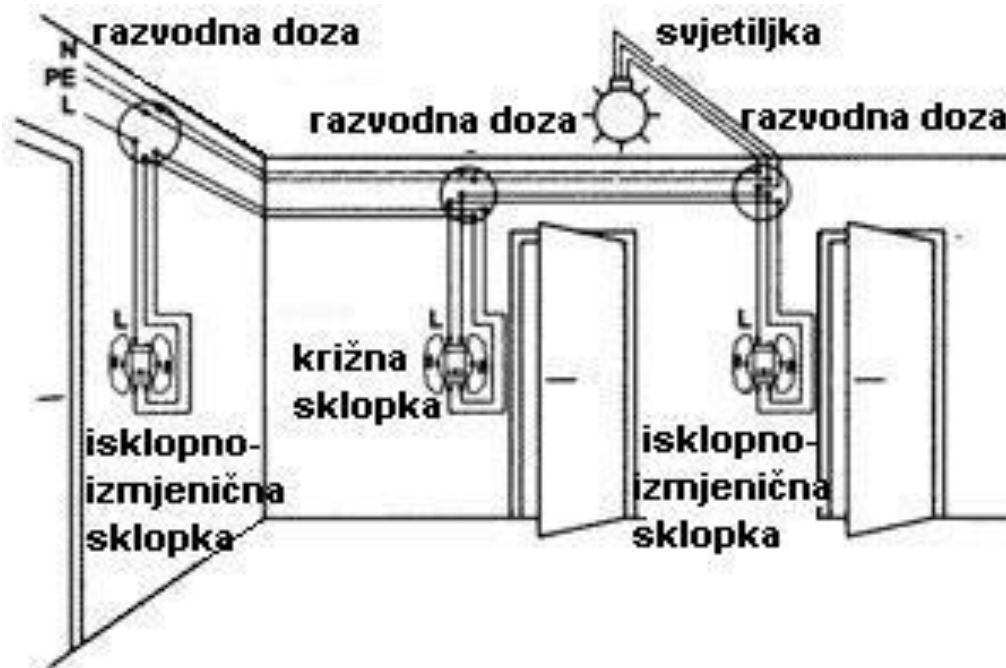
Sl. 2. Primjer jednostavnijih (kućnih) elektroinstalacija [22]
