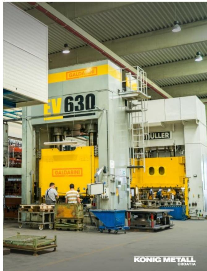
Slika 10 Hidraulične preše u proizvodnji
