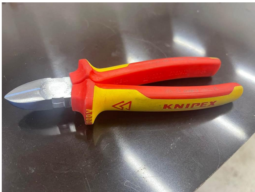
Slika 8. Izolirana kliješta za sječenje 1000V [Vlastiti izvor]
