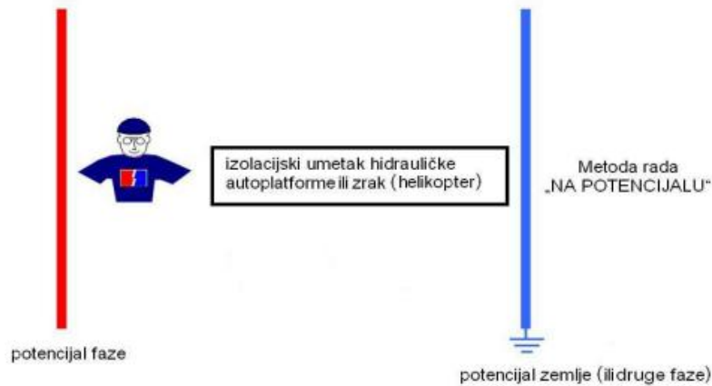
Slika 14. Metoda rada „na potencijalu“
