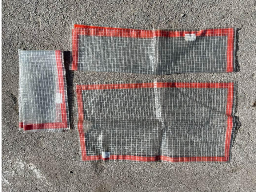
Slika 10. Savitljivi izolacijski pokrivač s ljepljivim trakama [Vlastiti izvor]
