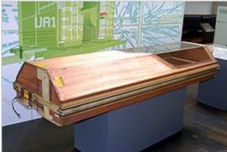
Slika 10. Povlačna komora- jedan oblik višeanodnog proporcionalnog brojača
