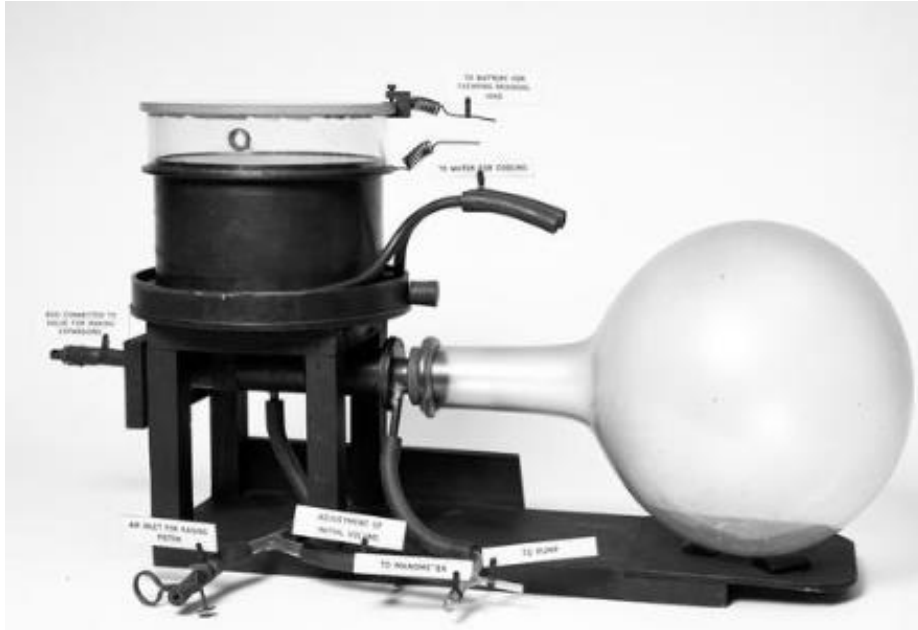
Slika 13. Originalna maglena komora napravljena u Cavendishev laboratoriju
