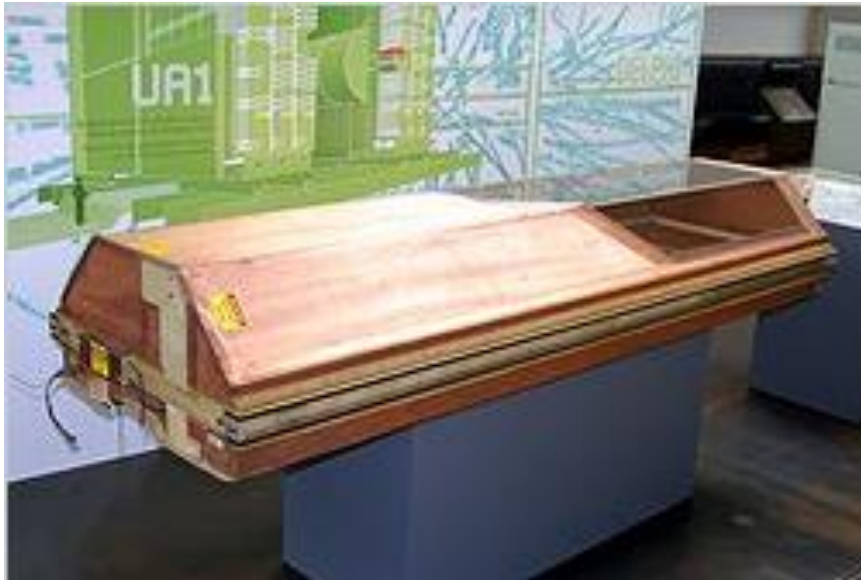
Slika 10. Povlačna komora- jedan oblik višeanodnog proporcionalnog brojača
