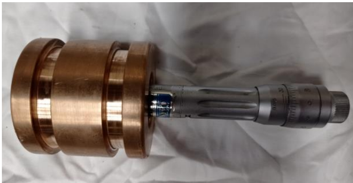
Slika 31. Nosač brtvila, \phi unutrašnji
