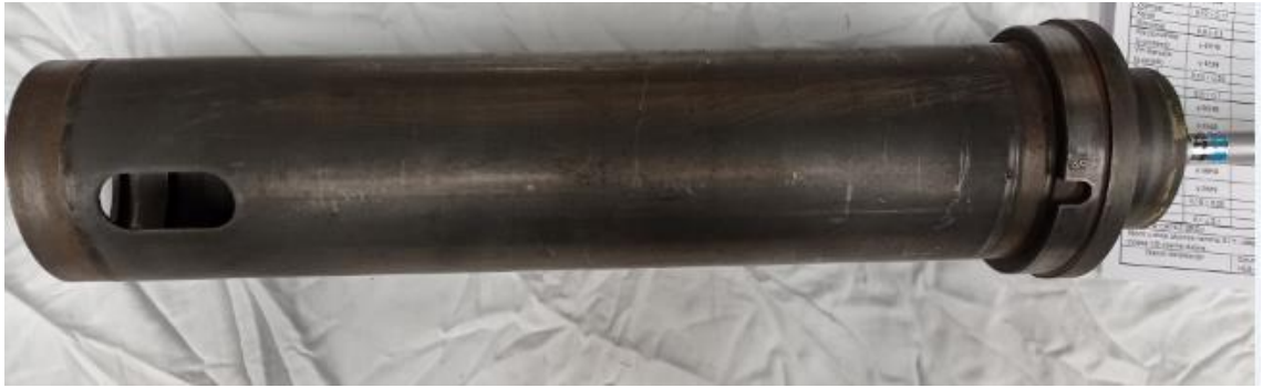
Slika 29. Cilindar srednji, kutija brtvjenja, \phi unutrašnji
