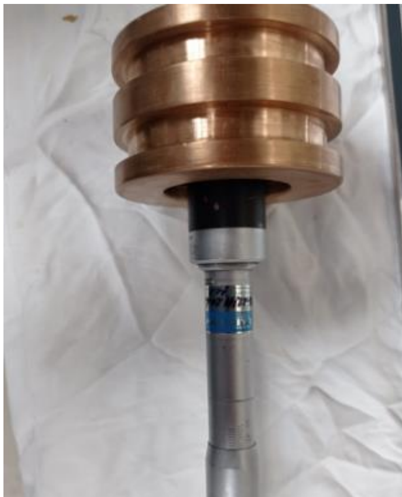
Slika 27. Nosač brtvila, \phi unutrašnji
