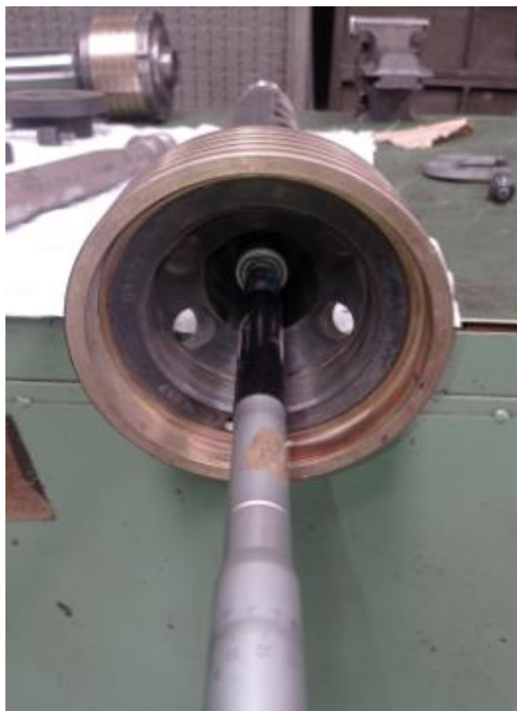
Slika 18. Klipnjača, \phi unutrašnji
