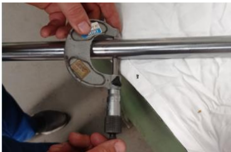
Slika 32. Klipnjača, \phi vanjski
