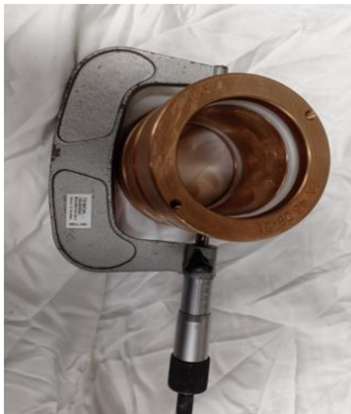
Slika 15. Nosač brtvila, \phi vanjski
