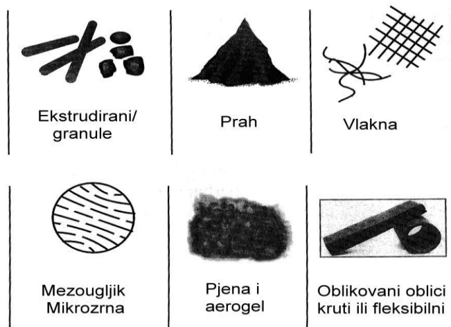
Slika 19. Vrste aktivnog ugljika
