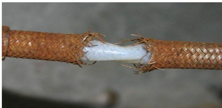
Slika 12: Probijeni omot od nehrđajućeg čelika i slomljeni PTFE [10].
