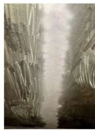
Slika 4. PT zavara između ploča brtvene stijene
