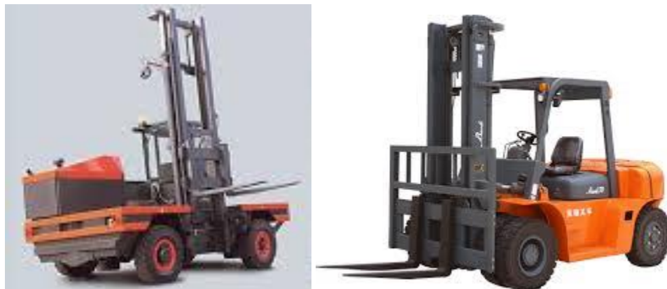
Slika 12. Bočni i čeoni viličar
