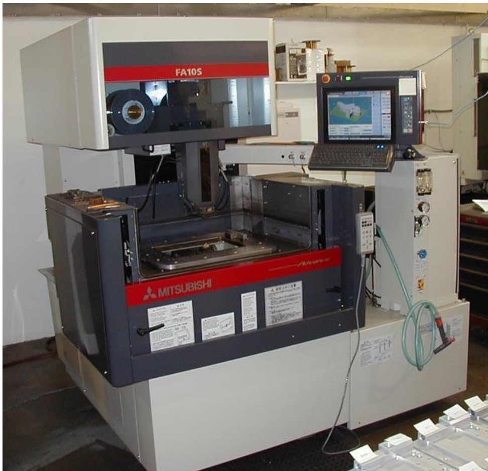
Slika 11 Uređaj za elektroerozijsku obradu žicom [6]
