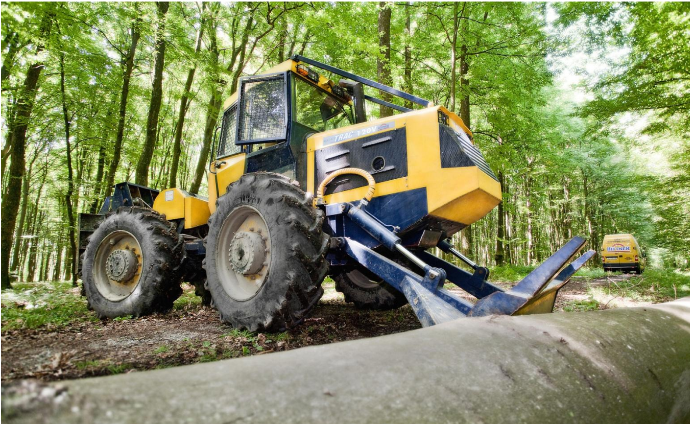
Slika 1. Izvlačenje drvnih sortimenata pomoću Hittnera
