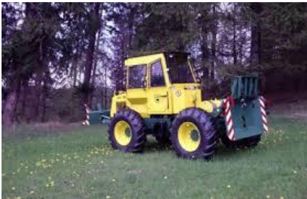
Slika 17. – Šumski zglobni traktor
