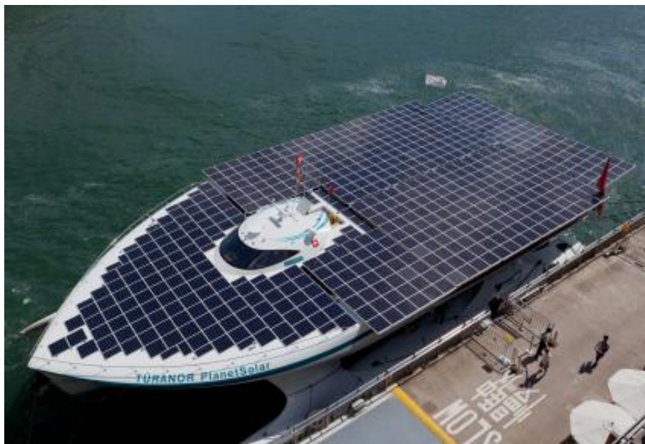
Slika 3.1. Solarno vozilo katamaran Planet Solar ( Turanor ); najveći današnji brod na solarni pogon
