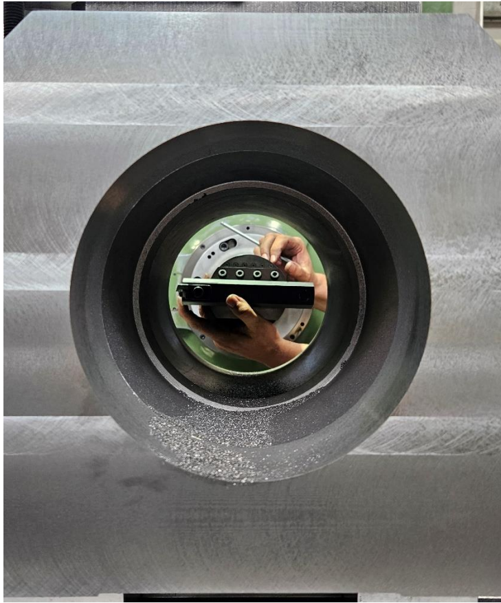
Slika 53. Priprema alata za završnu obradu na mjeru[Autor]
