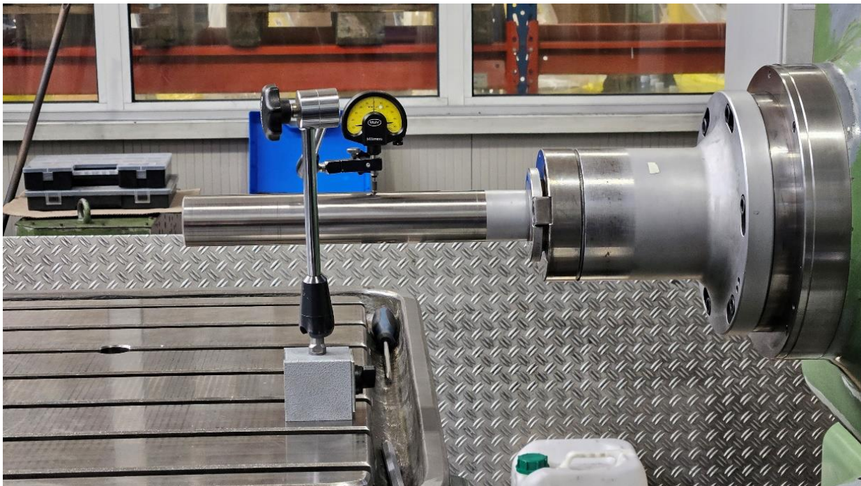
Slika 48. Mjerenje ravnosti stupova[Autor]
