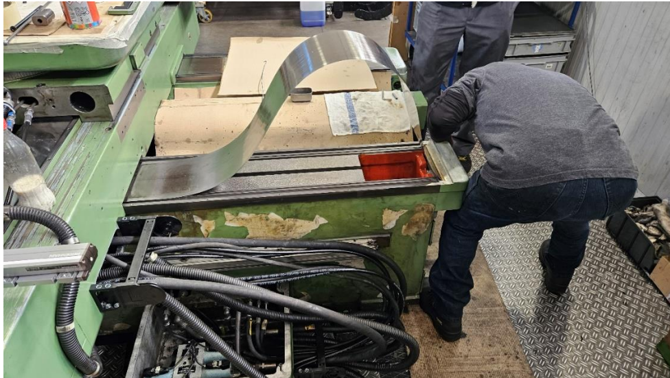
Slika 19. Novi zaštitni limovi za klizne staze[Autor]
