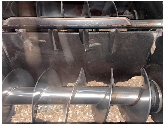
Slika 6. Razdjelni transportni puž [5]
