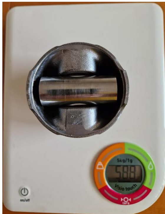
Slika 54. Vaganje klipa s zatikom
