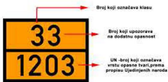
Slika 3. Ploča s Kemlerovim i UN-brojem tvari [2]
