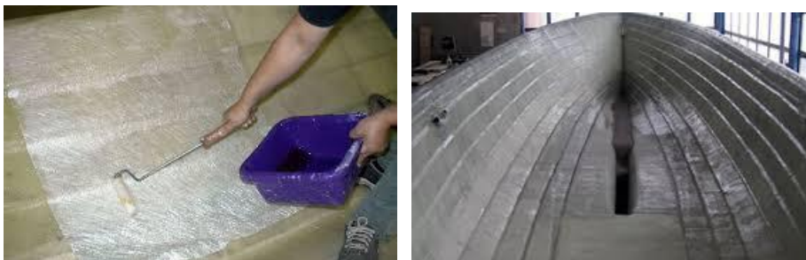
Slika 33 i 34. Izrada trupa broda od fibreglassa
