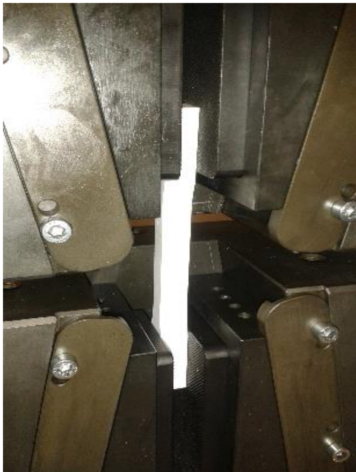
Slika 57. Pravilno postavljanje epruvete
