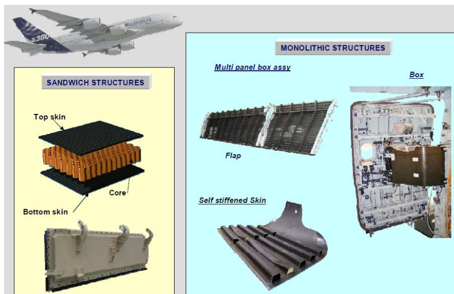
Slika 31. Vrste složenih kompozita u strukturi zrakoplova [3]
