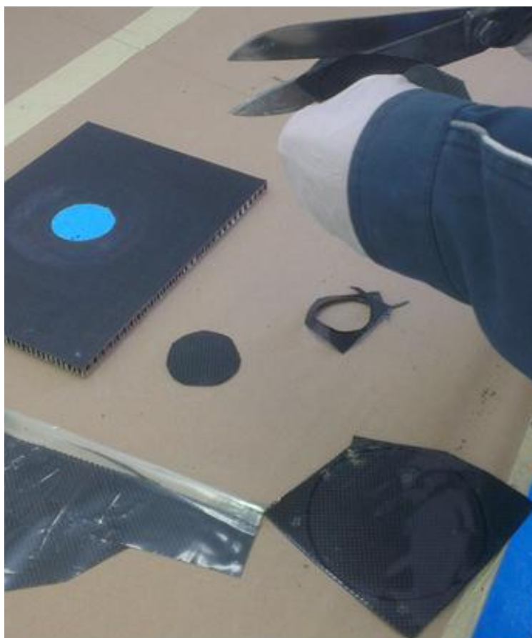
Slika 70. Rezanje drugog i trećeg sloja
